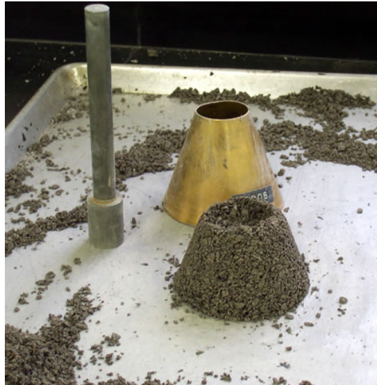
Figura 222 - 3. Agregado con humedad superficial
