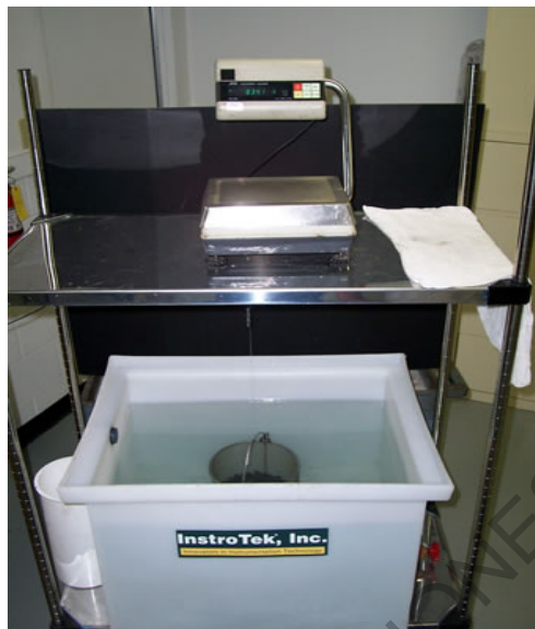
Figura 223 - 3. Determinación de la masa de la muestra sumergida
