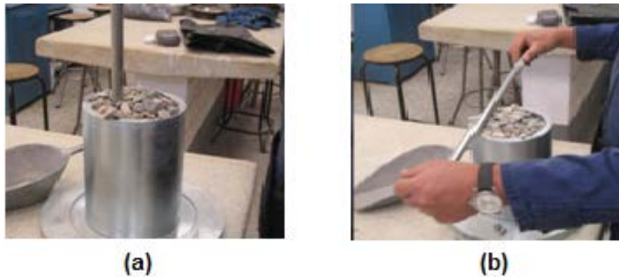
Figura 224 - 3. Determinación de la cantidad apropiada del agregado para el ensayo
