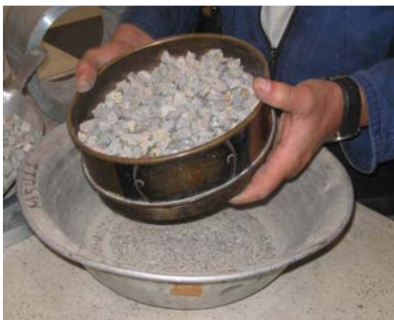
Figura 224 - 5. Tamizado sobre el tamiz de 2.36 mm (No. 8)
