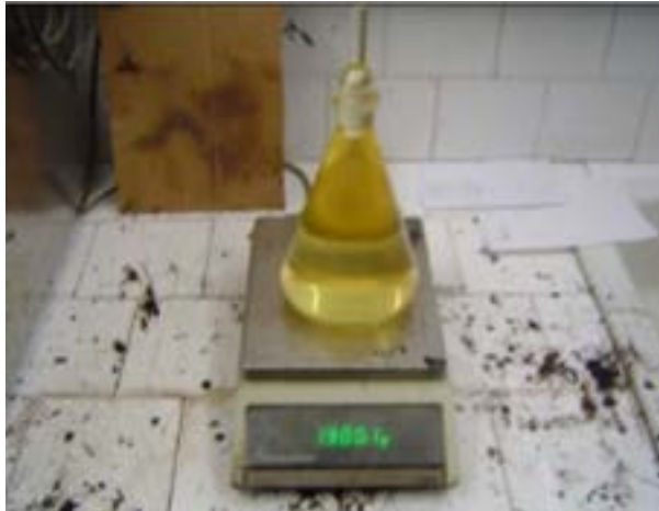
Figura 244 - 3. Determinación de la masa del picnómetro lleno de aceite hasta el enrase
