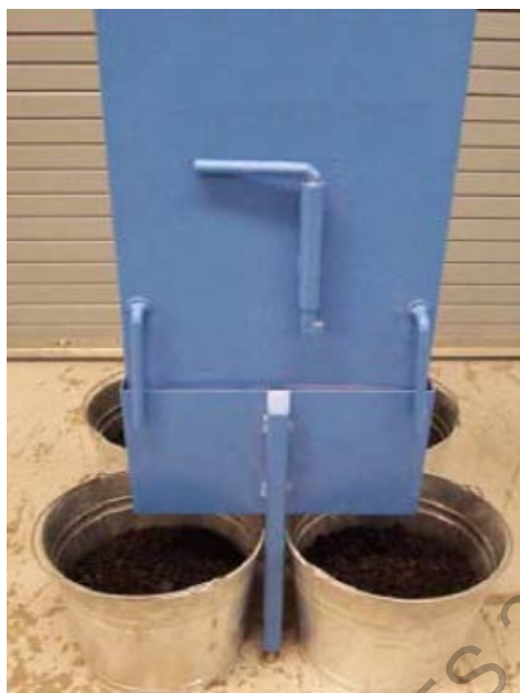
Figura 776 - 5. Recipientes con la muestra cuarteada
